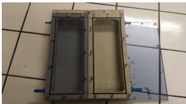
Figure 1 : Photographie d'un rhizotron (Crédit photo : C.PLESSIS)
