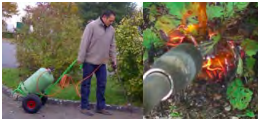
Figure 12 : Un désherbeur thermique
