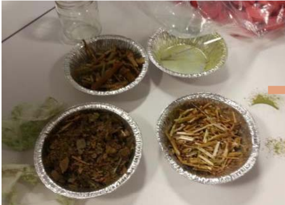
Échantillons après passage à l'étuve et broyage manuelle
